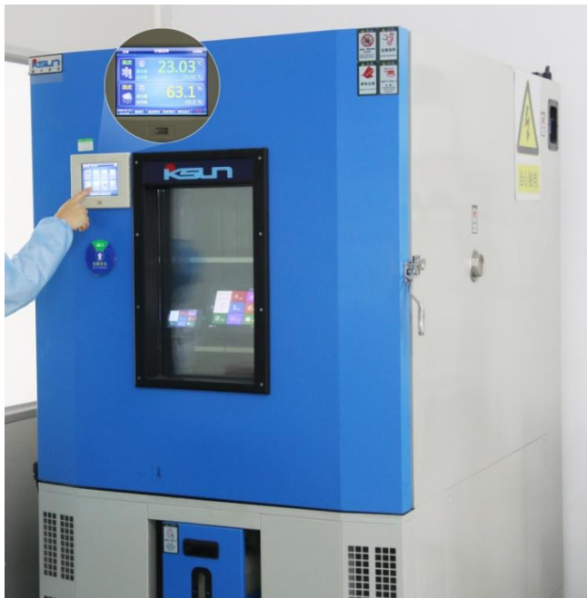
图 4-4 高低温老化测试图
